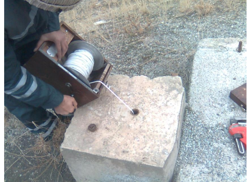
اندازه گیری سطح آب در گمانه ای در توف های سازند کرج
