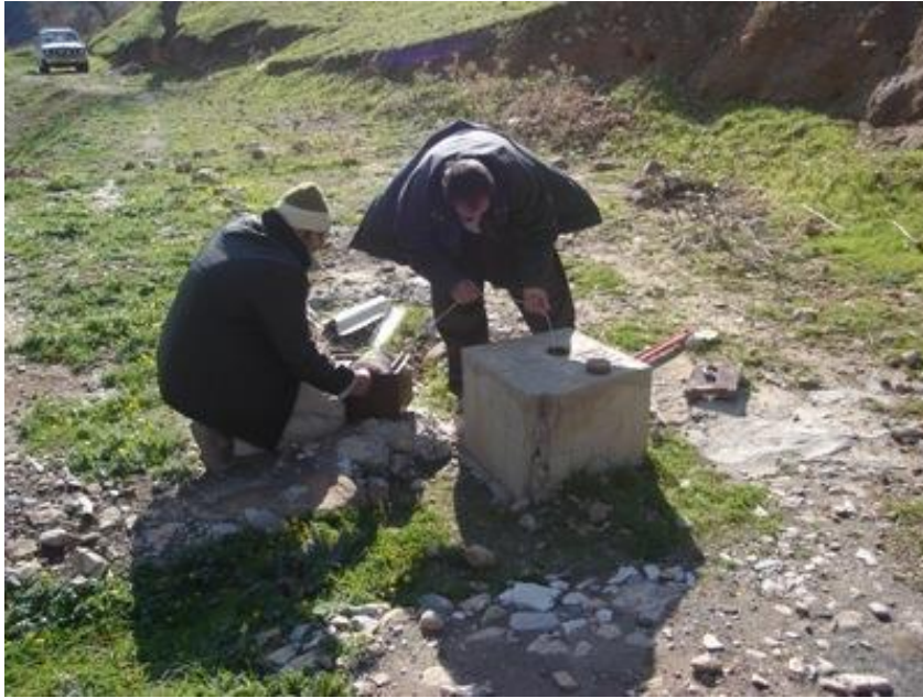
اندازه گیری سطح آب زیرزمینی در پیزومتری در منطقه کرمانشاه
